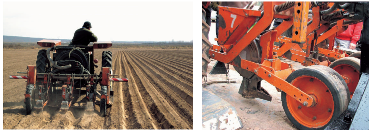
Figura 13. Equipo de siembra con formador de cama y sembradoras de precisión neumáticas.
