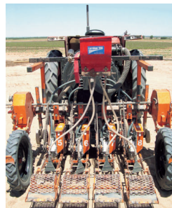
Figura 15. Máquina sembradora con aplicador de agroquímicos granulados (tolva roja).
