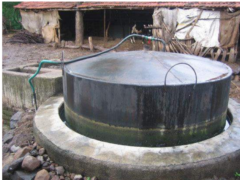
Figura 2.7. Planta de biogás con biodigestor tipo hindú
