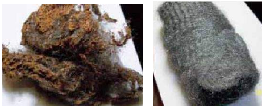
Figura 4.53. Comparación entre alambriña oxidada (izquierda) y no oxidada (derecha)
