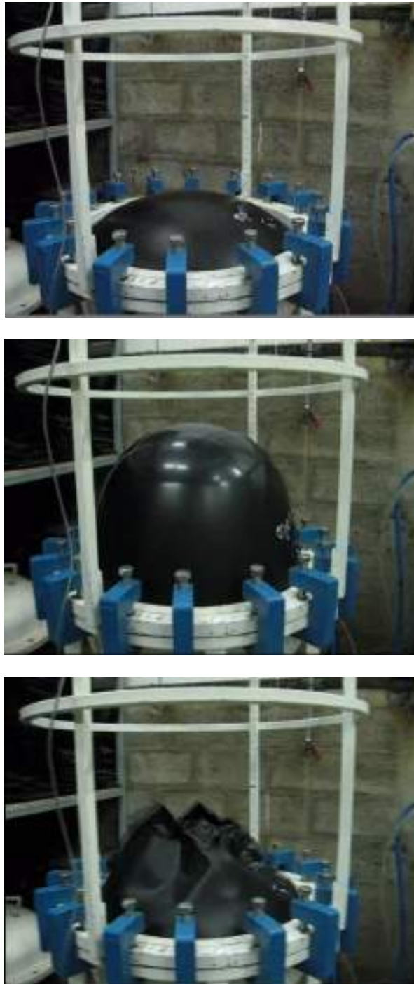
Figura 4.15 Prueba ASTM D5617 llevada a cabo en una geomembrana de HDPE
