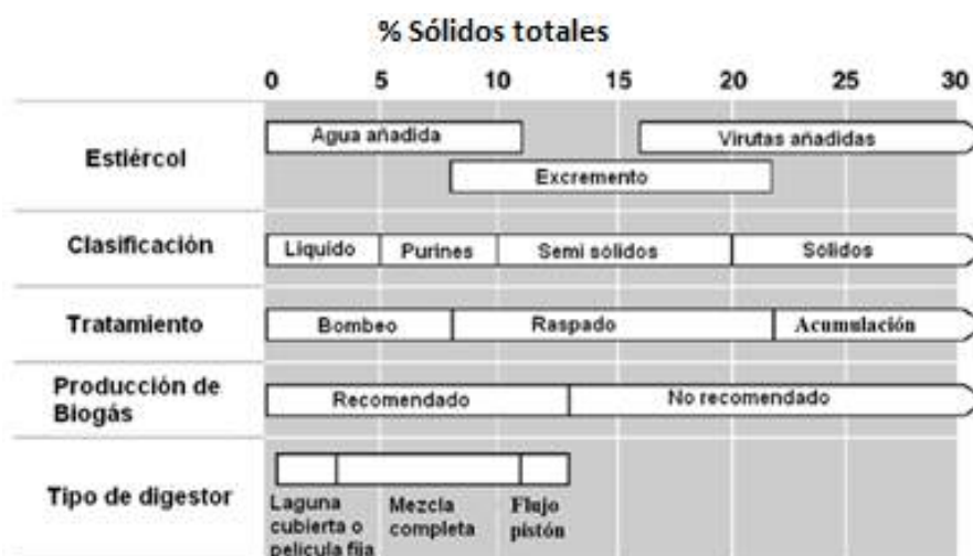
Figura 3.11. Características del estiércol animal y sistemas de manejo para la producción de biogás
