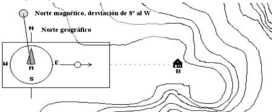
Fig. 44. Al centro de la brújula el punto “A”, de donde partimos al punto “B” que nuestro destino, el cual, está localizado al Este, justamente a 90°, para realizar el ajuste hay que sumar a los 90° los 8° de variación magnética, de lo que resulta 98°, que es el rumbo que deberemos seguir en nuestra brújula para llegar a B (Montero, 1993).
