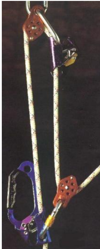
Fig. 96. Sistema tres a uno, técnica básica de rescate (Patzd, 1999).
