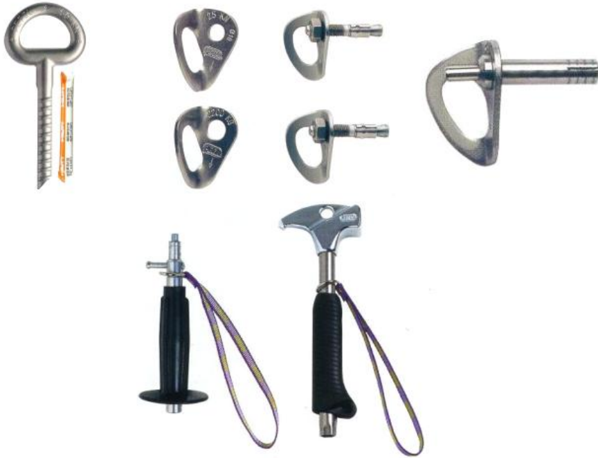
Fig. 61. Sistemas de anclajes artificiales perforantes o permanentes, de izquierda a derecha: anclaje químico, sin duda el mejor de todos (utiliza resinas); plaqueta; plaqueta con tornillo; long life; y abajo buril y martillo (Petzl, 1999).
