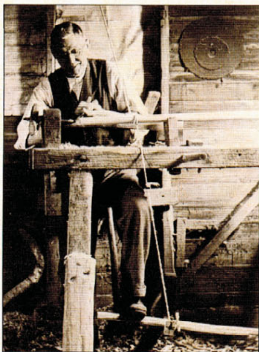
EL TORNO DE POLEA Una de las herramientas clásicas del artesano de la madera es el torno de polea (ver pág. 33-35 y 96). El pedal está conectado por una cuerda a la polea. Para poder dar vueltas un mango recto en él, el armazón del torno tiene que ser lo suficientemente amplio como para abarcar toda la longitud del mango. Con el torno de polea sólo se corta con el cincel cuando se ejerce presión en el pedal. Si se deja que el torno haga volver al pedal a su posición anterior, el cincel adopta una posición en la que no corta.
