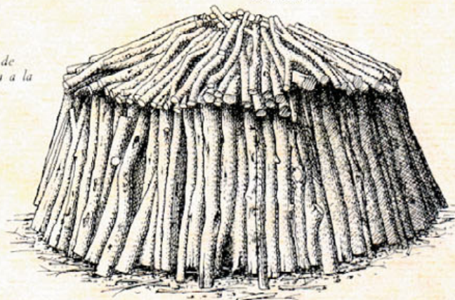
2 Comienza a apoyar troncos contra las tres caras de la chimenea, hasta formar un círculo en el que se deja, en su centro, el espacio hueco de la chimenea.
