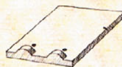
TEJAS PLANAS Poseen unos agujeros por los que se introducen los clavos, y las llamadas «narices», salientes que hacen que la teja quede bien fija, cuando los techos son empinados.
