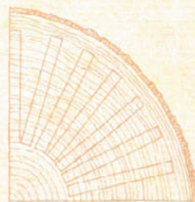
PATRÓN PARA CORTAR DUELAS DE UN TRONCO
