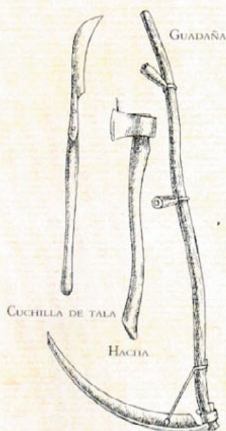
TIPOS DE MANGOS Un mango común tal como el de la cuchilla de tala puede obtenerse de un vástago verde de fresno. Para hacer el mango de una hacha se utiliza un tronco macizo de madera de veta curva. El largo mango de la guadaña tiene que ser vaporizado y moldeado.
